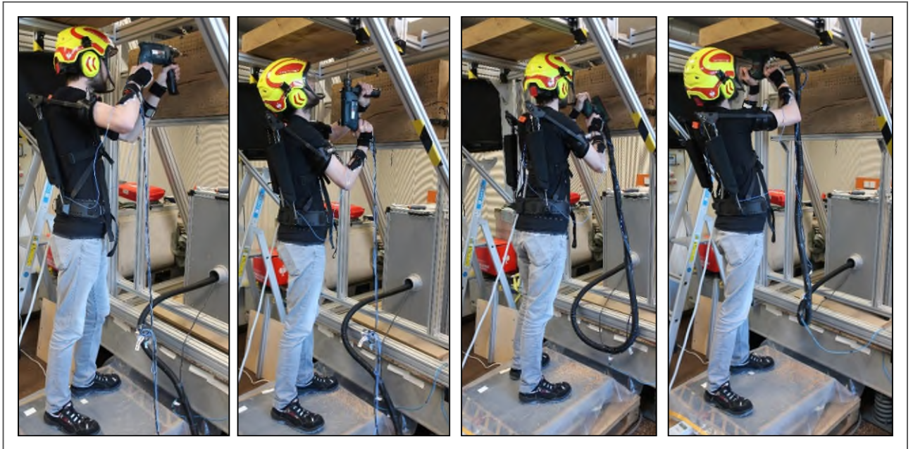
Abbildung 2: Arbeiten mit vibrierenden Geräten in verschiedene Richtungen mit Exoskelett 1. Von links nach rechts: Bohren in horizontaler Richtung, Bohren in vertikaler Richtung, Schleifen in horizontaler Richtung, Schleifen in vertikaler Richtung
