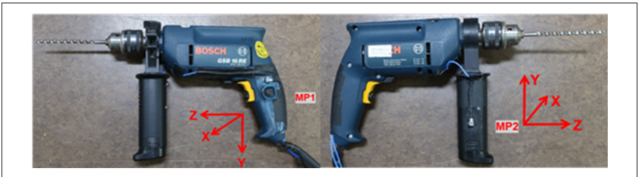
Abbildung 4: Anbringung und Achsenzuordnung der Beschleunigungssensoren - Bohrmaschine
