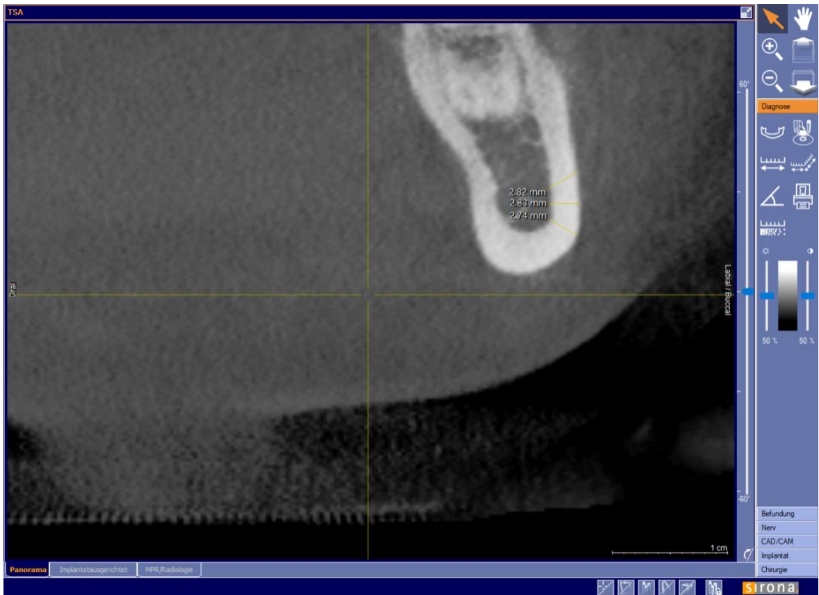
Abbildung A 8: Messung der Kortikalis-Dicke mittels Lineal-Tool
