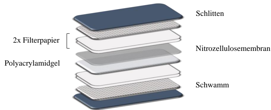
Abb. 9: Schematische Darstellung des Aufbaus der Blotapparatur.
