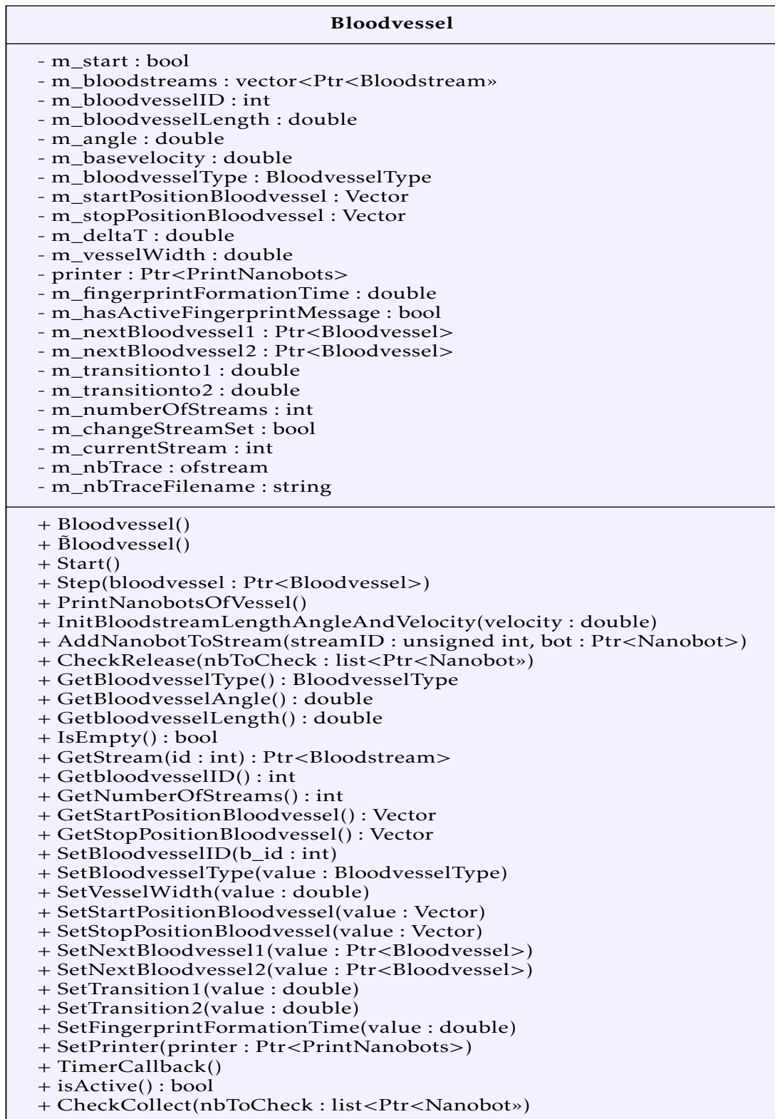
ABBILDUNG A.5 – UML-Klassendiagramm für die Klasse Bloodvessel.
