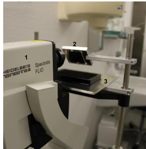
Abbildung 22 Modifizierung des Versuchsaufbaus von FLIO durch Positionierung eines Spiegels: links: technische Skizze; Quelle: modifiziert nach (21) S. 19; rechts: Der FLIO-Versuchsaufbau bestehend aus einem optischen System (1), Spiegel (2) und Objektisch mit Mikrotiterplatte (3); Quelle: eigene Aufnahme
