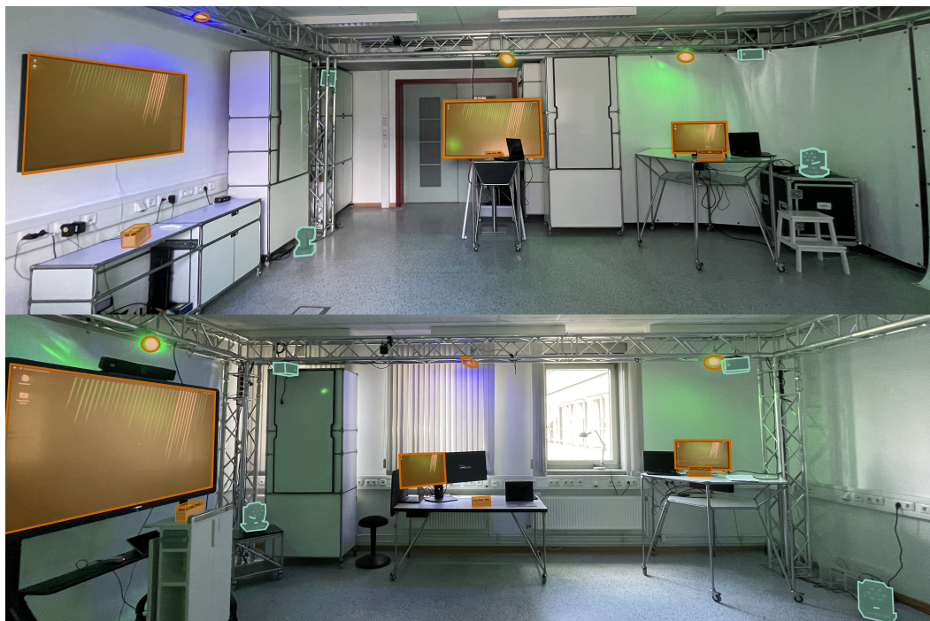
Abbildung 9.6: Die sechs im Raum verteilten Geräteverbände stellen den technischen Aufbau dar. Zu sehen sind die sechs Arcade Button Boards, sechs Displays für die Bedienoberflächen und die sechs Feedback-Lampen in der Traverse (in Orange markiert). Außerdem sind vier Moving Headspots für die Raumbeleuchtung und die Lautsprecher für die Tonausgabe zu sehen (in Mint markiert).
