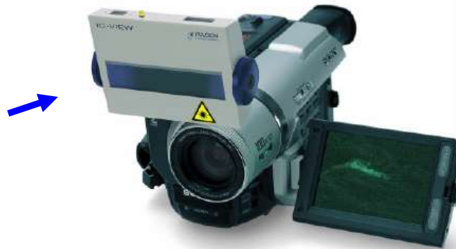
Abb. 03: IC-View der Firma Pulsion [26]; blauer Pfeil: Töns-Leuchte
