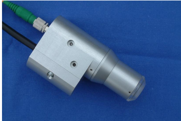
Abbildung 4-16: Oben: Der Applikator besteht aus drei Hauptbaugruppen. Dem Handstück, dem Linsenmodul und dem Applikator-Kopf. Dadurch kann das Linsenmodul bei Bedarf durch ein anderes (mit anderer NA) ersetzt werden. Mitte: Das Handstück bildet die zentrale Baugruppe. An der Rückseite befindet sich die CMOS-Kamera. Der Kollimator ist in einer Passung verschiebbar. Auf diese Weise kann die optische Weglänge verändert werden. Um die Fokusslage auf der Probe zu verändern, kann die Abbildungslinse mittels eines Fokussierings in ihrer Position verschoben werden.
