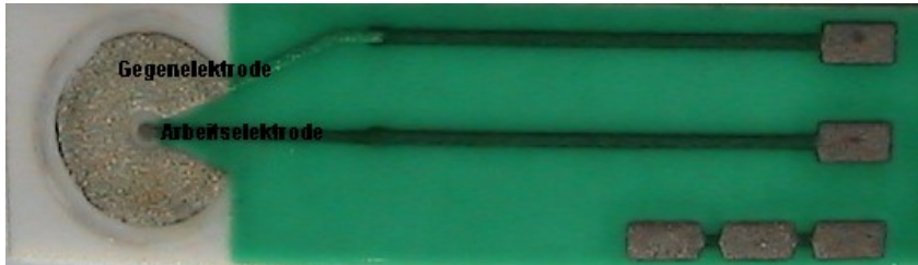
Abbildung 3.2.3.2.: Dickschicht-Glukosesensor der Firma BST Maßstab 5:1
