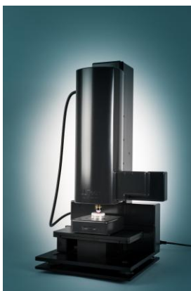
Abbildung 17: LightCT - Kommerzielles FF-TD-OCT der Firma LLTech Imaging zur optischen Biopsie an ex vivo Gewebe. Das System erfasst en face OCT-Bilder bei einer isotropen Auflösung von 1 \mu\text{m}^3 und basiert auf einem Linnik-Interferometer. Die Probe wird in einem Probenhalter unter dem Objektiv positioniert und mit einem Immersionsmedium in Kontakt zum Objektiv gebracht. Durch Verschiebung des Interferometers entlang der Tiefe können Volumenaufnahmen aufgezeichnet werden.
