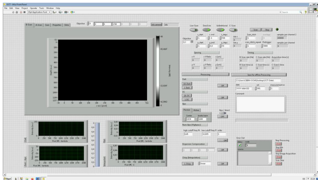
Abbildung 33: LabVIEW-Programm zur Ansteuerung der xposure-Zeilenkamera - Die grafische Benutzeroberfläche stellt alle Parameter auf der rechten Seite dar. Die Echtzeit B-Scan Visualisierung erfolgt auf der linken Seite. Daneben können einzelne A-Scans visualisiert werden und die Scan-Parameter für die galvanometrischen Scanner eingestellt werden. Auf der rechten Seite können die Scanparameter wie Anzahl der A-Scans, Größe des Messfeldes und Stitching mehrerer Volumen direkt modifiziert werden. Durch die Schaltfläche ‚Processing‘ wird die Online-Prozessierung zur Darstellung von A- und B-Scans aktiviert. Nach einer aufgezeichneten Messung können alle Metadaten über die Schaltfläche ‚Save for offline Processing‘ abgespeichert werden.
