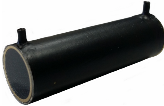
Abbildung 21: Durchflussküvette mit 50 mm Pfadlänge und 12 mm Innendurchmesser.
