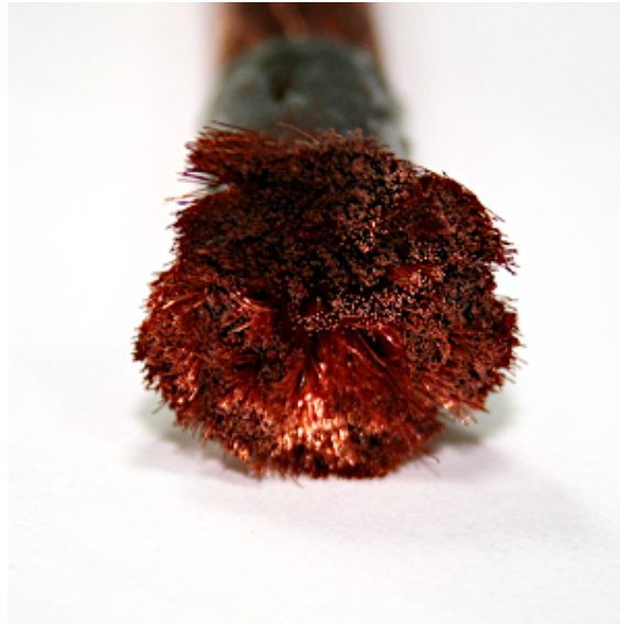
Abbildung 5.4: Die unter anderem für den AF-Generator verwendete HF-Litze mit 10000 63\text{-}\mu\text{m} -Einzeldrähten.
