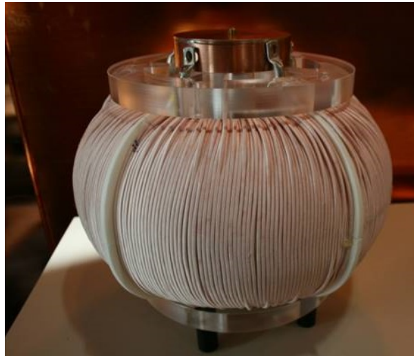
Abbildung 7.1: Luftkernspule des Auskopplungskreises zur Vermessung des Partikelsignals ohne dedizierte Empfangsspule. Zur Reduktion des ohmschen Widerstands wurden je drei Windungen parallel gewickelt.
