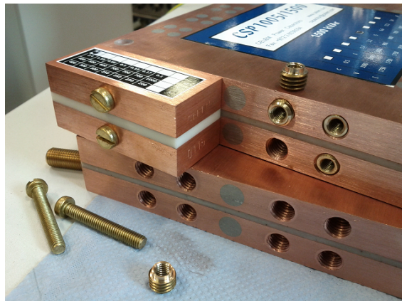
Abbildung 4.13: Die verbauten Kondensatoren wurden entsprechend ihrer Strombelastbarkeit und aufgrund des niedrigen Klirrfaktors gewählt. Zudem ermöglichen sie einen modularen Zusammenbau. Teile der Schraubverbindungen wurden durch nichtmagnetische Werkstoffe ersetzt.
