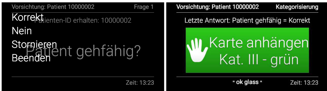
Abbildung 48: Sprachmenü zum Beantworten der Frage nach der Gehfähigkeit (links) und Kategorisierung des Patienten in die Kategorie III mit Farbcode grün (rechts).
