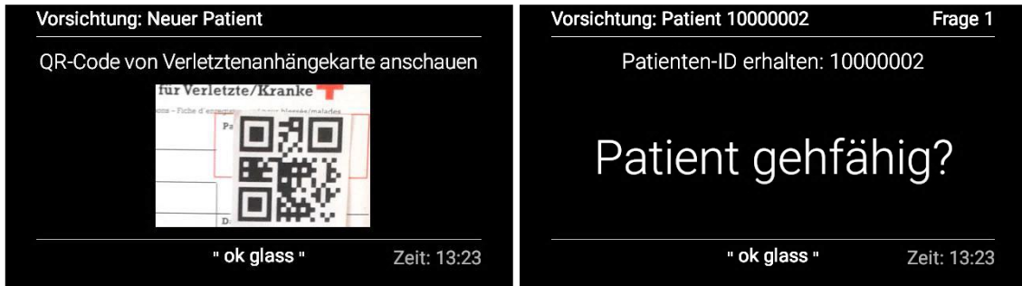
Abbildung 47: Erste Ansicht der Anwendung zum Einlesen des QR-Codes einer Verletztenanhängekarte (links) und die nach dem Einlesen folgende Ansicht mit der ersten Frage des Algorithmus (rechts).
