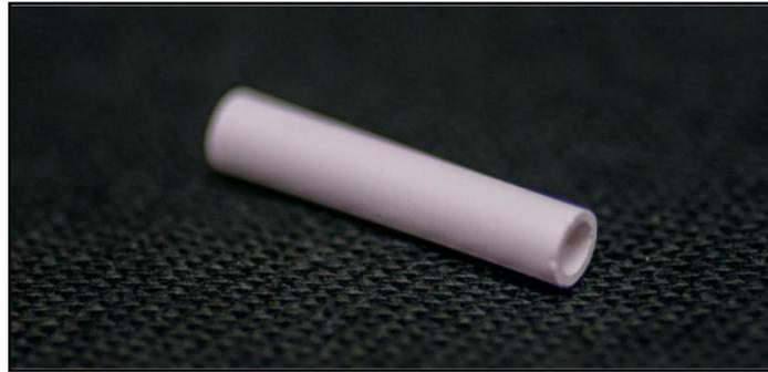
Abb. 1-10: Poröser  $Al_2O_3$ -Röhrchen
