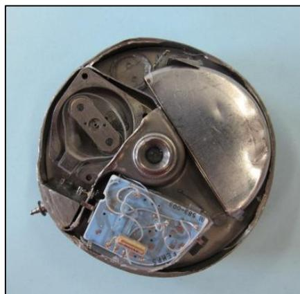
Abb. 1-5: Implantierbare Infusionspumpe mit elektronischer Steuerung für einen einstellbaren Flow (Synchronmed II, Fa. Medtronic)
