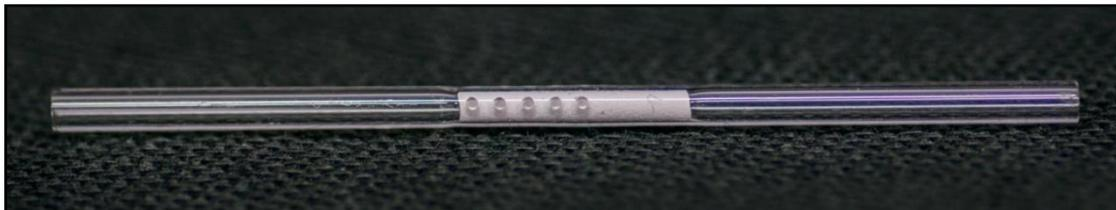
Abb. 1-8: Poröser Vollzylinder in einer Glaskapillare
