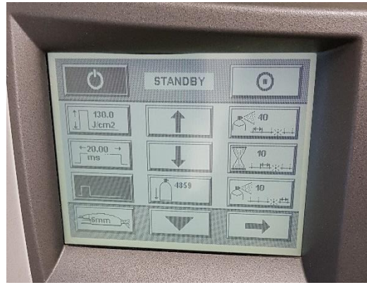
Abb. 11.2 Verwendete Einstellungsparameter für den Nd:YAG-Laser ®GentleYAG
