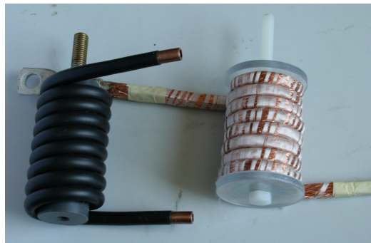
Abbildung 7.2 – Feldgeneratorspulen aus Kupferrohr und HF-Litze
