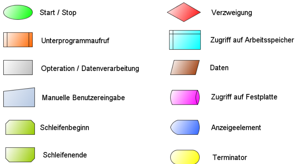
Abbildung 3.13 – Flussdiagrammsymbole nach DIN Norm 66001
