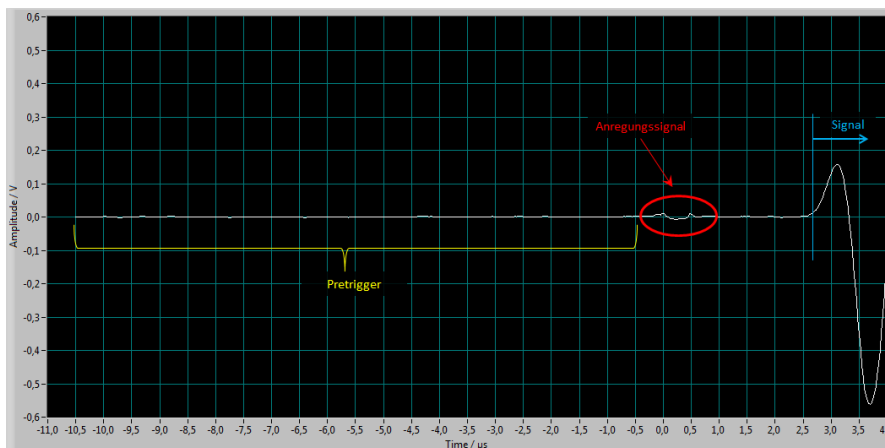
Abbildung 3.14: Veranschaulichung des Pretriggers Über die Software kann ein Pretrigger (gelb) eingestellt werden, der die Messaufnahme vor der Anregung (rot) startet. Über den gelben Bereich kann das Rauschen bestimmt werden. In blau eingezeichnet ist der Zeitpunkt, ab dem das Ultraschallsignal am Empfänger ankommt.
