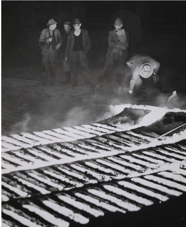
Abbildung 40: Flüssiges Roheisen kühlt in den Masselbetten ab. (Quelle: Archiv Industriemuseum Geschichtswerkstatt Herrenwyk)
