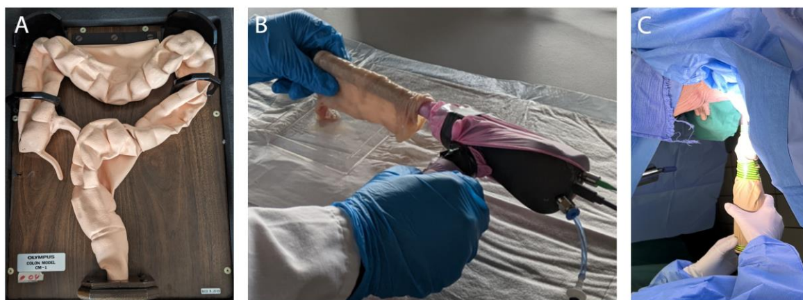
Abbildung 4.6 Evaluationsproben für rektoskopische OCT-Anwendungen. Fotos des A) künstlichen Darm-Trainingsmodells, B) Rek1-Prototyps im ex vivo Schweinedarm, C) Rek2-Prototyps im Rektum des Körperspenders.
