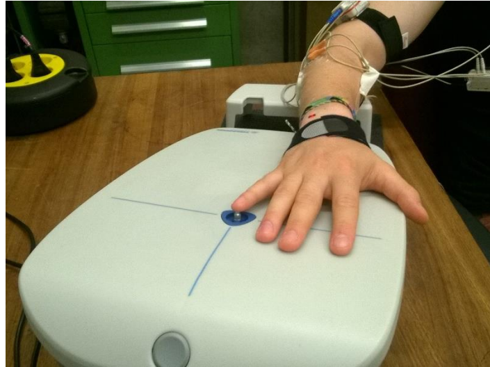
Abbildung 9: Messung der Vibrationsempfindungsschwelle mit dem VibroSense Meter II
