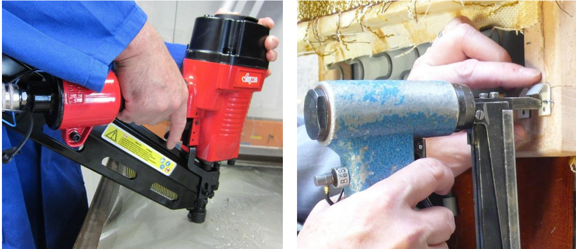
Abbildung 1: Verwendung von Druckluftnagler (links) und Klammernagler (rechts) als Beispiele für handgeführte Geräte mit stoßhaltigen Emissionen
