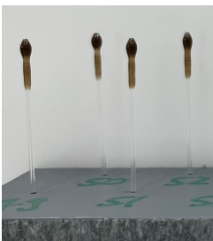
Abbildung 13: Vergleich von je vier exemplarischen Proben je nach Beschichtungszeitpunkt nach einer Synthesedauer von 2 h 10 min (a) und 2 h 30 min (b) nach Erreichen von 160 °C. Oben: Proben nach Synthese. Unten: Proben nach 2 h im Trockenschrank bei 37 °C.
