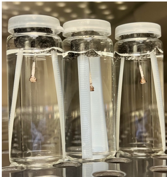
Abbildung 10: Proben im Wasserbad. Die Kapillaren wurden in einer Halterung aus Schaumstoff fixiert. Um einen Kontakt der Beschichtung mit dem Probengläschen zu vermeiden, wurden zwei Stützelemente aus Kunststoff in den Schaumstoff eingebracht.
