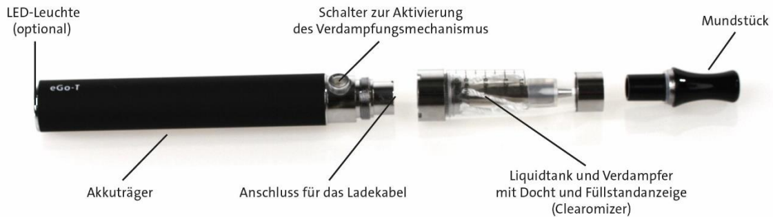
Abbildung 8: Aufbau einer E-Zigarette am Beispiel der eGo-T (aus DKFZ, Stabsstelle Krebsprävention; 03/2022)
