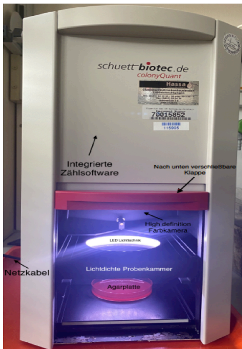
Abbildung 9: Koloniezählgerät schuett colonyQuant von der Firma schuett-biotec GmbH , Göttingen. Die Agarplatte wird in der Probenkammer des Geräts platziert und bei Dunkelheit (mit geschlossener Klappe) mit der integrierten hochauflösenden Farbkamera von oben fotografiert.
