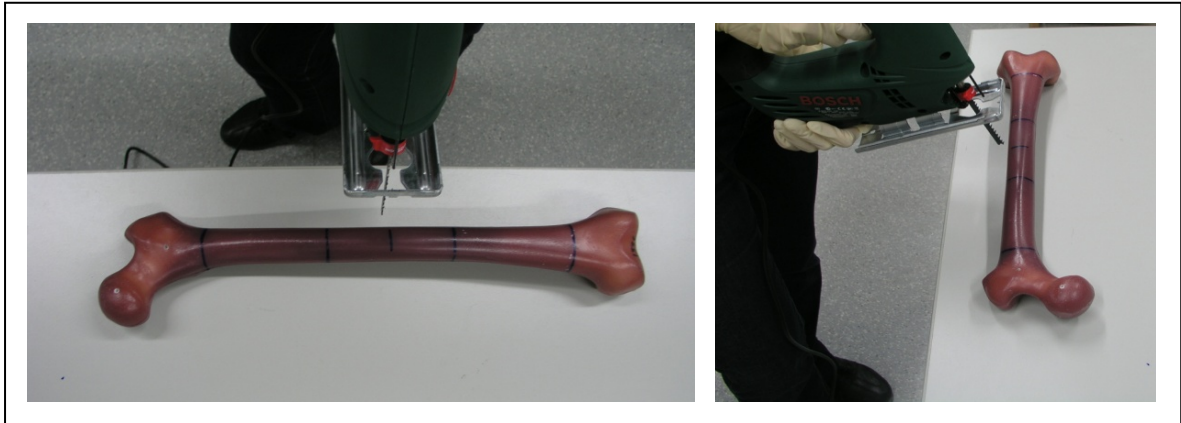
Abbildung 9: Standardisierte Herstellung der Querfraktur mittels Bandsäge.
