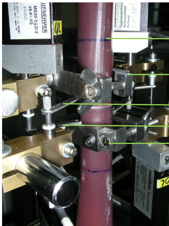
Abbildung 15: Messaufbau zur Messung der axialen Kompression
