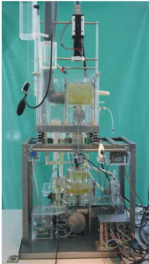
Abb. 10: Bild (links) und schematische Darstellung (rechts) des Pulsduplikators. (1) atriale Vorlast, (2) Scheibenventil, (3) Kolbenpumpe, (4) Antrieb mit Steuerscheibe, (5) Ventrikel-Compliance, (6) Untersuchungskammer, (7) Umlenk-Kammer, (8) höhenvariable Flüssigkeitssäule, (9) Aorten-Compliance, (10) peripheres Widerstandselement, (P) Drucksensor, (Q) Volumensensor, (13) Hochgeschwindigkeitskamera
