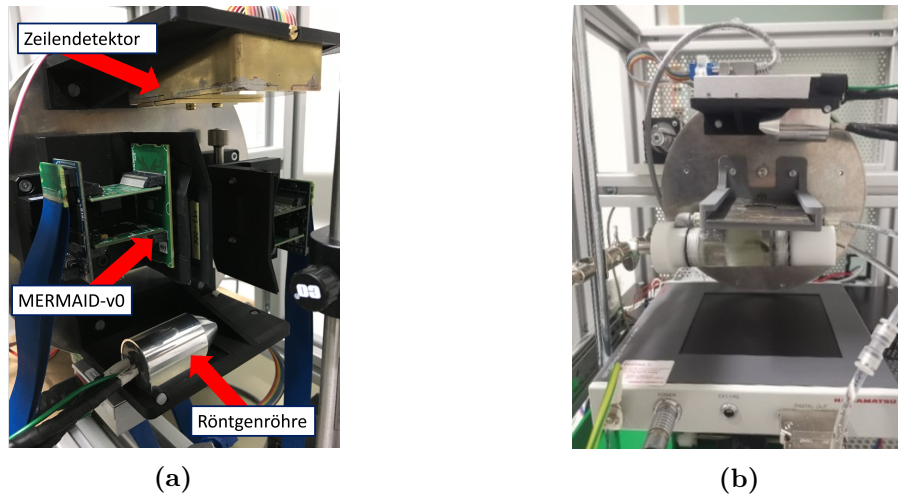
Abbildung 5.5.: (a) Röntgenröhre und Liniendetektor, hinter Messingabschirmung montiert, auf der rotierenden Scheibe neben den beiden Detektormodulen des ersten Prototyps. (b) Experimenteller Einbau des Flächendetektors in MERMAID, hier bei einer Testmessung mit Bildgebungskammer. Bilder aus Unterabschnitt A.5.3.2.
